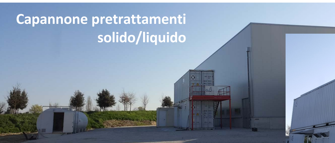
Unità containerizzata a 3 stadi di Osmosi inversa
